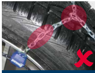
montaggio errato (catena attorcigliata) mauvais montage: croisillons emmêlés (merci de les démêler)
